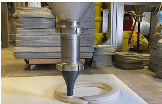
RTU izstrādātā betona 3D druka
